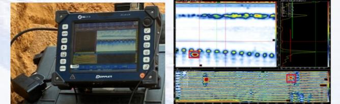
聚乙烯管道热熔对接接头的TOFD检测
